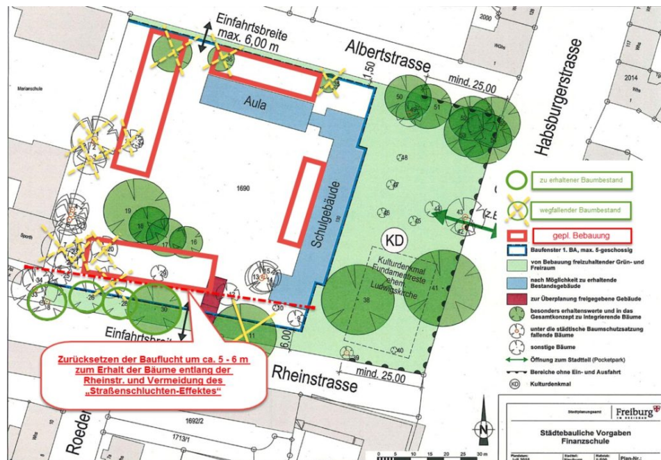
Vorschlag des Forum Neuburg und der Anwohner beim Bauvorhaben der Finanzschule in der Rheinstraße: Zurückversetzung des Baukörpers an der Rheinstraße (hinter die rot gestrichelte Linie) und dadurch Erhalt der Bäume an der Straße.
